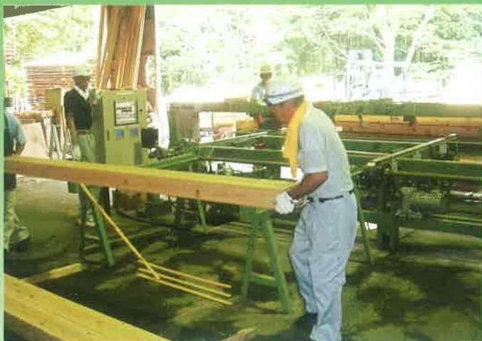
ヤング係数、含水率の測定（グレーディングマシン）
